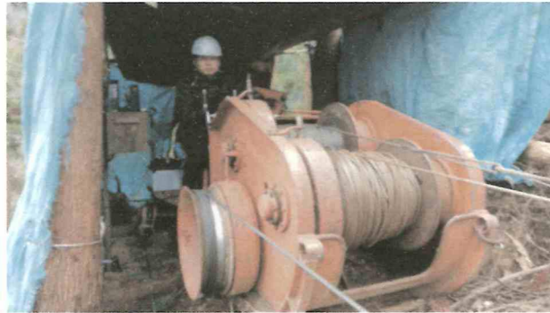
油圧集材機による架線集材
